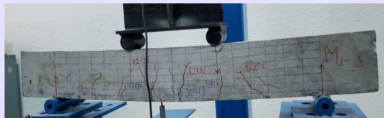
Thí nghiệm nén đầm mẫu M1
